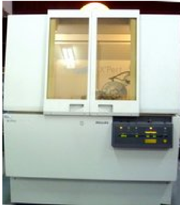
รูปที่ 1 เครื่องเอกซเรย์ดิฟแฟรกโทมิเตอร์ (X-ray Diffractometer)
