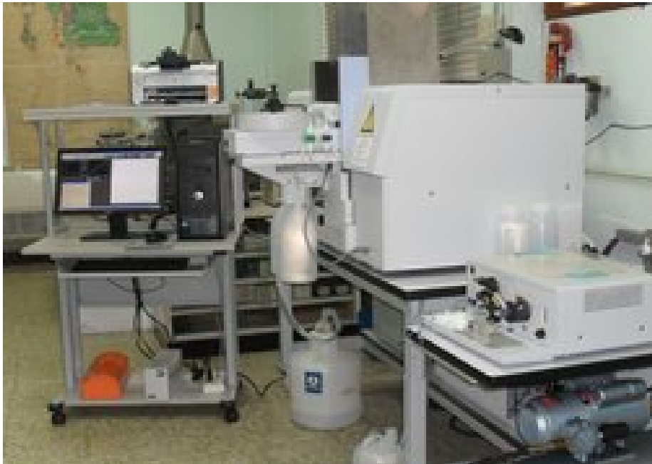
รูปที่ 9 เครื่อง Graphite Furnace-Atomic Absorption Spectrometer; GF-AAS
