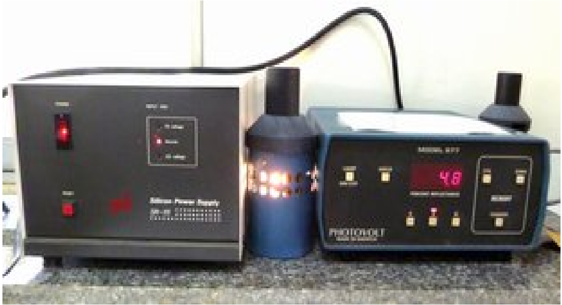
รูปที่ 5 เครื่องตรวจความขาวสว่าง (Brightness)
