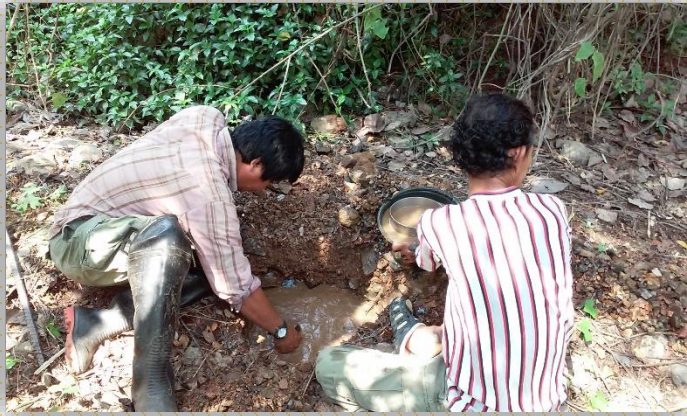
รูปแสดงการเก็บตัวอย่างแร่หนักจากตะกอนท้องน้ำ
