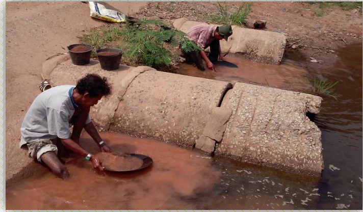
รูปแสดงการเสียดแร่หนักจากตะกอนท้องน้ำ
