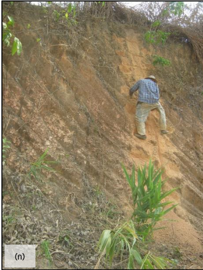
(ก) การทำความสะอาดหน้าตัดชั้นดิน
