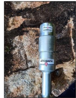
นำกระบอกเก็บตัวอย่าง ใส่ตรงปลายเครื่องตอกเก็บตัวอย่าง
