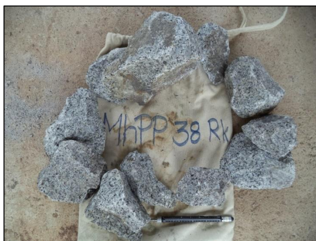
รูปที่ 5.2 การคัดเลือกตัวอย่างหินสด เพื่อเตรียมส่งวิเคราะห์เคมี ศึกษาทิวลาพรรณนา และเป็นตัวอย่างอ้างอิงและศึกษาต่อยอด
