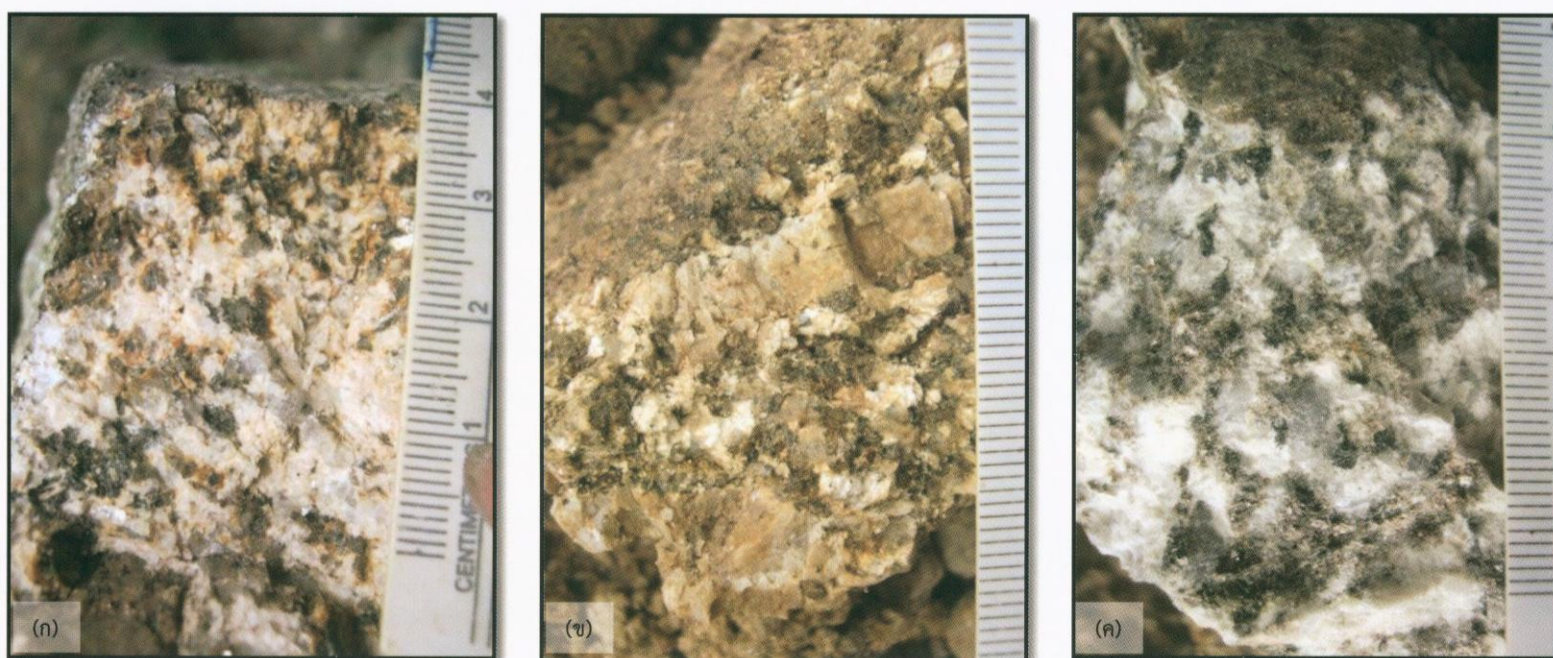
รูปที่ 12 ลักษณะเนื้อหินแกรนิตที่พบในพื้นที่ (ก) หินแกรนิตเนื้อทิวร์มาลีน-มัสโคไวต์-ไบโอไทต์ เนื้อขนาดเดียว (ข) หินแกรนิตเนื้อไบโอไทต์ เนื้อดอก (ค) หินแกรนิตเนื้อมัสโคไวต์-ไบโอไทต์ เนื้อขนาดเดียว
