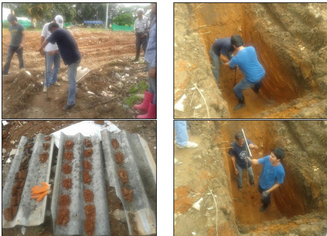
รูปที่ 1-11 การเก็บตัวอย่างตะกอน โดยการเจาะแบบสว่านมือหมุน และชุดหลุมสำรวจ
