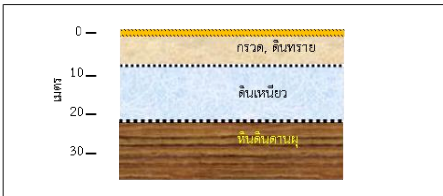
รูปที่ 12-11 สภาพชั้นตะกอนและชั้นหินบริเวณพื้นที่ที่จะสร้างอาคารเรียนทดแทน โรงเรียนพานพิทยาคม
