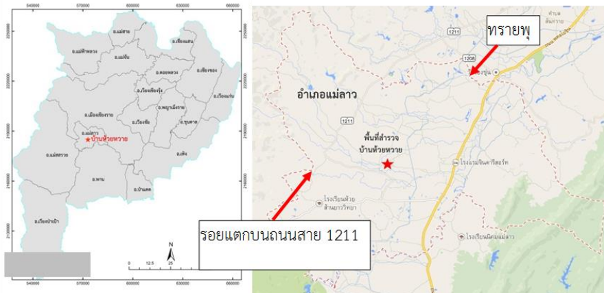
รูปที่ 8-2 พื้นที่สำรวจบริเวณบ้านห้วยห้วย ต.ดงมะตะ อ.แม่ลาว จ.เชียงราย แสดงการสำรวจรอยแตกบนถนนโดยวิธีการหยั่งลึกด้วยสัญญาณเรดาร์ แนวเส้นสำรวจ ระยะทาง 952 เมตร และสำรวจธรณีวิทยาใต้ดินบริเวณที่เกิดทรายพุด โดยการวัดความต้านทานไฟฟ้าแบบภาพตัดขวาง เส้นสำรวจระยะทาง 115 เมตร และวัดความต้านทานไฟฟ้าแบบหยั่งลึก จำนวน 2 จุด
