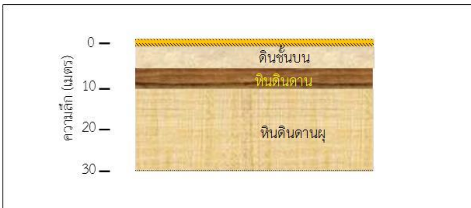
รูปที่ 16-19 สภาพชั้นหินบริเวณพื้นที่ 1 จะสร้างอาคารเรียนทดแทน โรงเรียนร่องธารวิทยา
