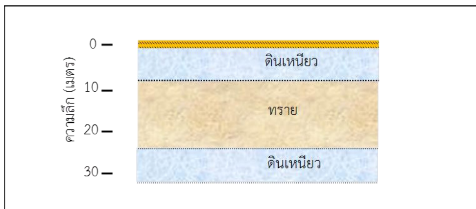
รูปที่ 15-12 สภาพชั้นหินบริเวณพื้นที่จะสร้างอาคารเรียนทดแทน โรงเรียนสันกลางวิทยา
