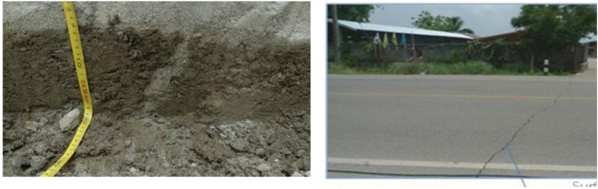
รูปที่ 8-3 แสดงลักษณะทรายพูนพื้นดิน และแนวแตกบนถนนสาย 1211
