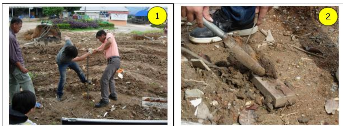
รูปที่ 13-15 ภาพเจาะมือหมุน (1) และหัวเก็บตัวอย่าง (2)
