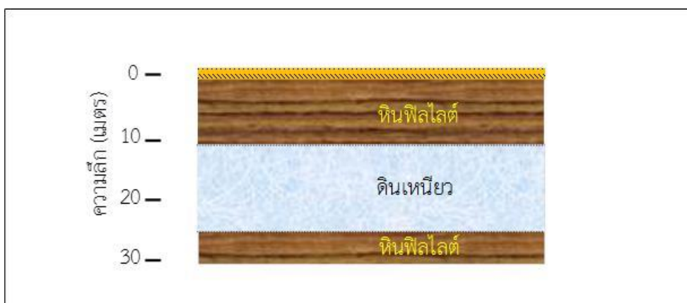
รูปที่ 19-18 สภาพชั้นหินบริเวณพื้นที่สนามฟุตบอลโรงเรียนดอยช้าง มีความเหมาะสมสามารถ สร้างอาคารเรียนทดแทนได้
