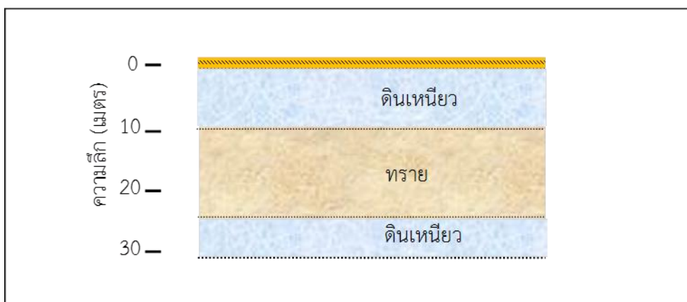
รูปที่ 14-13 สภาพชั้นหินบริเวณพื้นที่จะสร้างอาคารเรียนทดแทน โรงเรียนเจริญเมืองวิทยา
