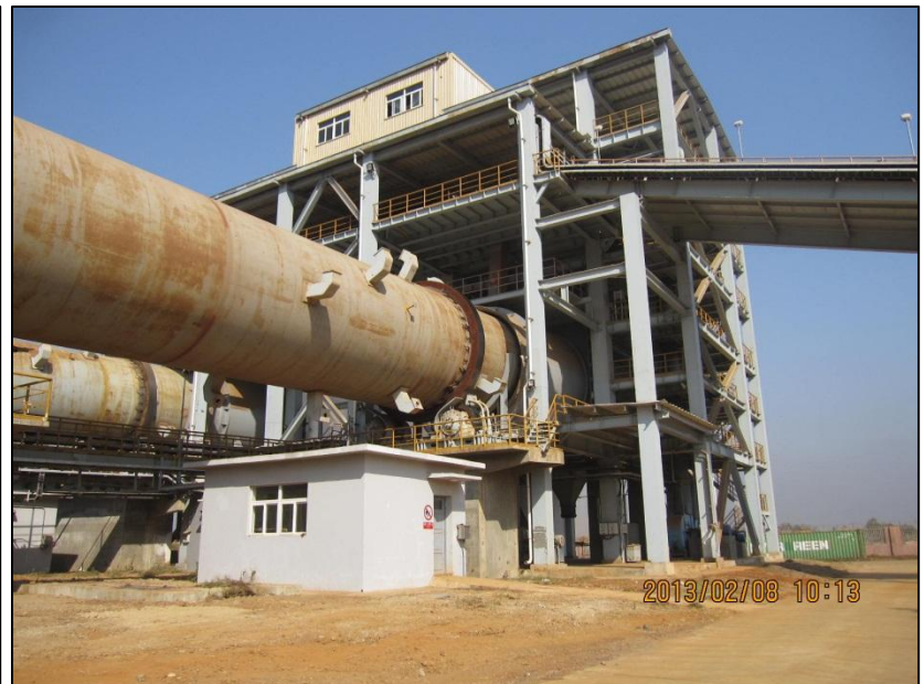
Dryer 4.5 m \Phi x 40 mL (2 nos.)
