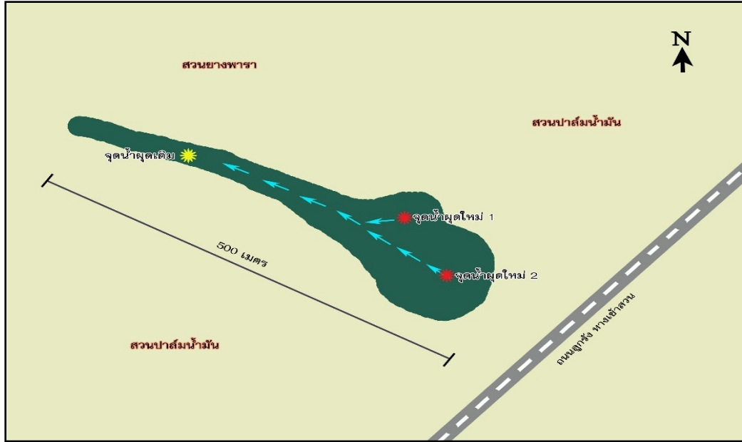
รูปที่ ๓ แผนที่แสดงลักษณะการเกิดแผ่นดินทรุดตัว
