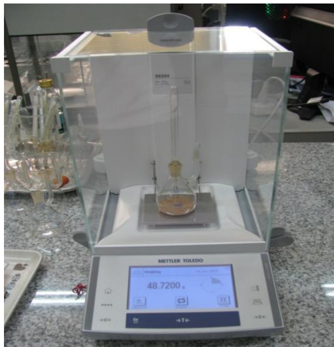
รูปที่ 6 เครื่องชั่งหาค่าความถ่วงจำเพาะ (Specific gravity determination balance)
