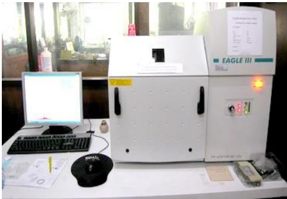
รูปที่ 2 เครื่อง Energy Dispersive X-ray Fluorescence Spectrometer ; EDXRF
