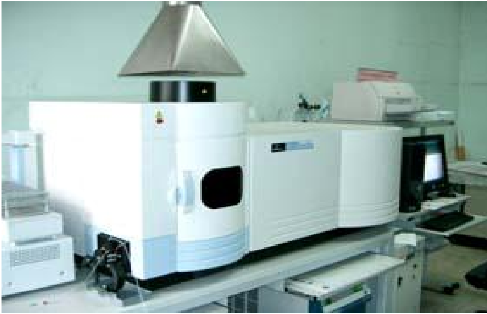
รูปที่ 11 เครื่อง Inductively Coupled Plasma Optical Emission Spectrometer; ICP-OES
