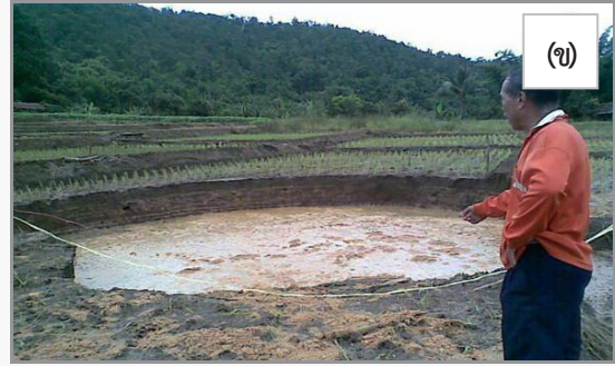
รูปที่ 4-11 ตัวอย่างหลุมยุบที่เกิดขึ้นในบริเวณที่มีโพรงหินปูนใต้ดินระดับตื้น
