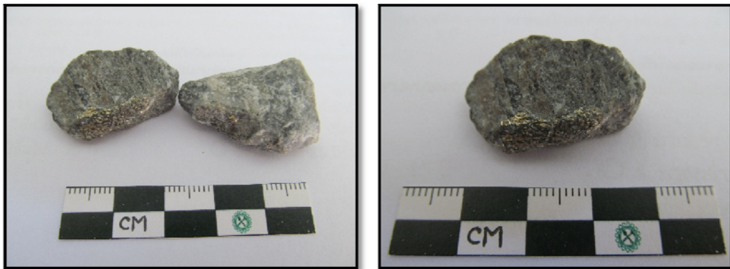
รูปที่ 1 ลักษณะของไพไรต์ที่ฝังประปรายในเนื้อหินปูนเนื้อดิน บริเวณลานจอดรถหลังตลาดสุขสวัสดิ์ ซอยเอกชัย 66 แขวงบางบอน เขตบางบอน กรุงเทพมหานคร
