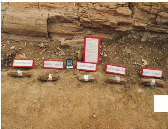
รูปที่ 3 การวางตัวอย่างจัดวางตำแหน่งให้ใกล้กับไม้กลายเป็นหินท่อนใหญ่ ก. หลุมขุดค้นที่ 1 (มีหลังคา) ข. หลุมขุดค้นที่ 2 (ไม่มีหลังคา)
