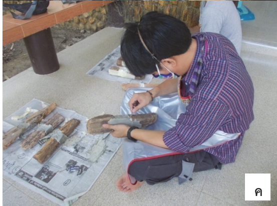
รูปที่ 2 ขั้นตอนการเชื่อมประสานไม้กลายเป็นหิน ก. ทำความสะอาดตัวอย่าง ข. ทำแม่พิมพ์และเทวัสดุเชื่อมประสาน ค. ตกแต่งด้วยมีดผ่าตัดทางการแพทย์ ง. ตัวอย่างพร้อมนำไปวางทดสอบยังหลุมขุดค้น
