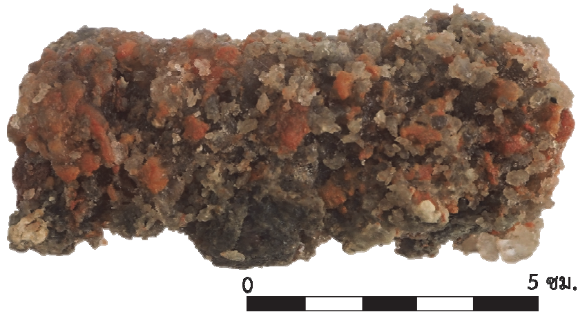
รูปที่ 1 ภาพตัวอย่าง K201-56 ประกอบด้วยแร่คาร์เนลไลต์ ซิลิไต์ แอไลต์และแอนไฮไดรท์
