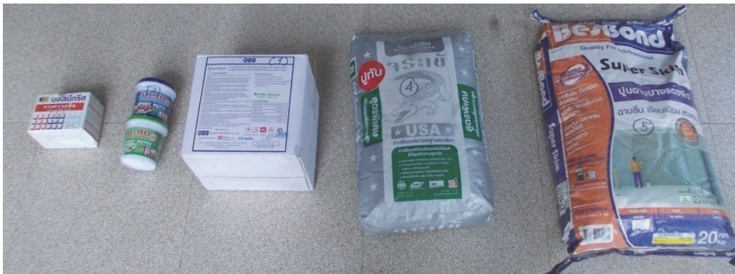
รูปที่ 1 วัสดุเชื่อมประสาน 5 ชนิด ก. อีพ็อกซี่ (Epoxy Adhesives) ข. กาวคอนกรีต (Epoxy Putty – 534) ค. ปูนทันตแพทย์ (Dental Plaster – Type III /greenstone) ง. กาวซีเมนต์ (จระเข้เงิน) จ. ปูนฉาบ (Super Skim)
