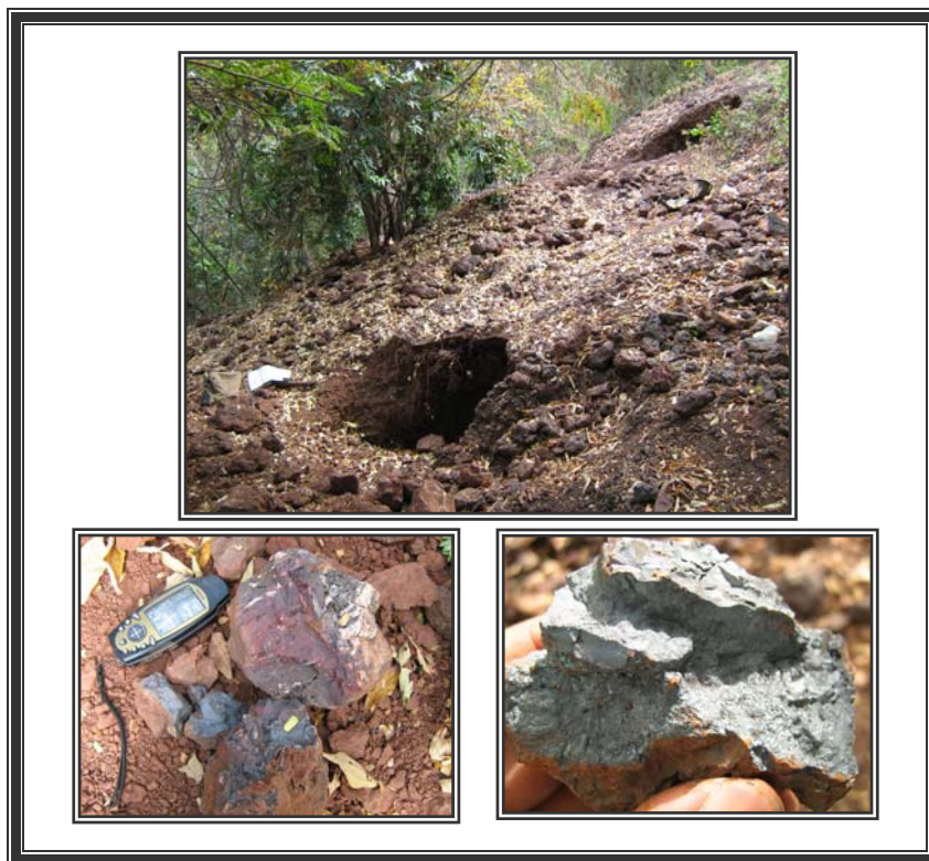
รูปที่ 6-9 (บน) ลักษณะพื้นที่แหล่งแร่เหล็กอิมคลิม ตำบลหนองรี อำเภอบ่อพลอย มีลักษณะของการขุดอุโมงค์หาแร่ (ล่าง) สินแร่เหล็กประเภทฮีมาไทต์และเกอไทต์ (แดง) และตะกรันเหล็กจากการถลุง
