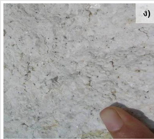
รูปที่ 6-6 แหล่งแร่โซเดียมเฟลด์สปาร์ของบริษัทเซอร์มาสจำกัด ประทานบัตรเลขที่ 28297/15582 ที่ตำบลวังจันทร์ อำเภอสามเงา ก) และข) กองแร่ที่ stock ไว้ก่อนนำส่งขาย ค) บริเวณหน้าเหมือง โซนแร่กว้างประมาณ 30 เมตร มองไปทางทิศใต้ ง) ภาพถ่ายระยะใกล้แสดงลักษณะแร่โซเดียมเฟลด์สปาร์ สีขาว ขนาดเม็ดแร่ปานกลางถึงหยาบ
