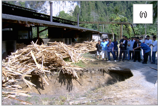
รูปที่ 4-12 ตัวอย่างหลุมยุบในหลายพื้นที่ทางภาคใต้ของประเทศไทย ที่มีสาเหตุมาจากการเกิดแผ่นดินไหวขนาด 9.1 ตามมาตราริกเตอร์ เมื่อวันที่ 26 ธันวาคม 2547
