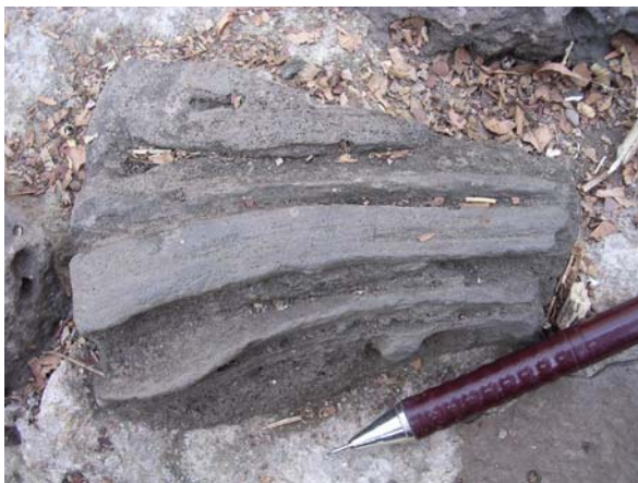
รูปที่ 3-25 หินบะซอลต์แบบปายออยออย เขากระโดง ตำบลเสมีต อำเภอมืองบุรีรัมย์ (0294967/1652646N)
