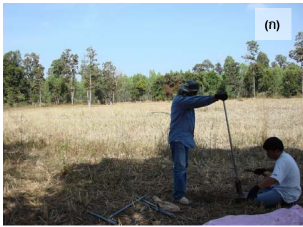
รูปที่ 3-18 ลักษณะของหน่วยตะกอนตะพักลำนํ้ามาศที่ได้จากการเจาะสำรวจด้วยเครื่องเจาะแบบมือหมุน บริเวณบ้านหนองโดน ตำบลบ้านยาง อำเภอลำปลายมาศ จังหวัดบุรีรัมย์ (0265789E/1643691N)
