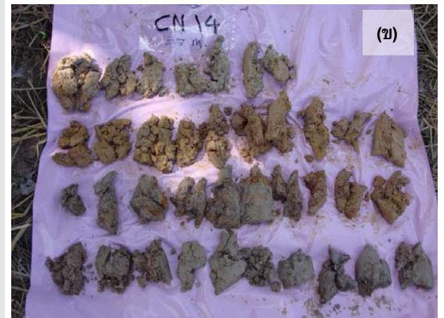
รูปที่ 3-18 ลักษณะของหน่วยตะกอนตะพักลำนํ้ามาศที่ได้จากการเจาะสำรวจด้วยเครื่องเจาะแบบมือหมุน บริเวณบ้านหนองโดน ตำบลบ้านยาง อำเภอลำปลายมาศ จังหวัดบุรีรัมย์ (0265789E/1643691N)
