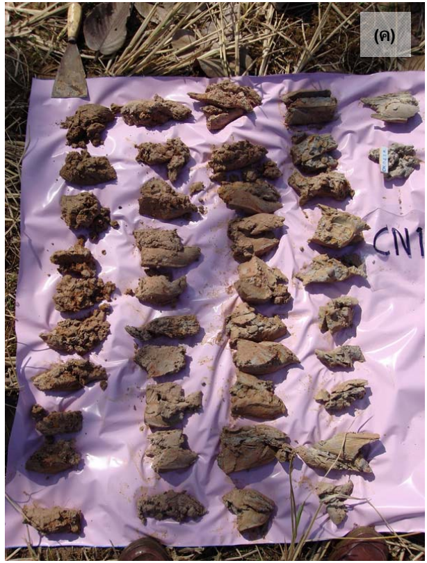
รูปที่ 3-21 ลักษณะหน่วยตะกอนน้ำพา (Qa) ของลำน้ำมาศจากการเจาะสำรวจด้วยเครื่องเจาะแบบมือหมุน บริเวณบ้านหนองโดนน้อย ตำบลหนองโดน อำเภอลำปลายมาศ และบ้านโคกเพชร ตำบลซำฮี อำเภอลำปลายมาศ (0269179E/1649525N)
