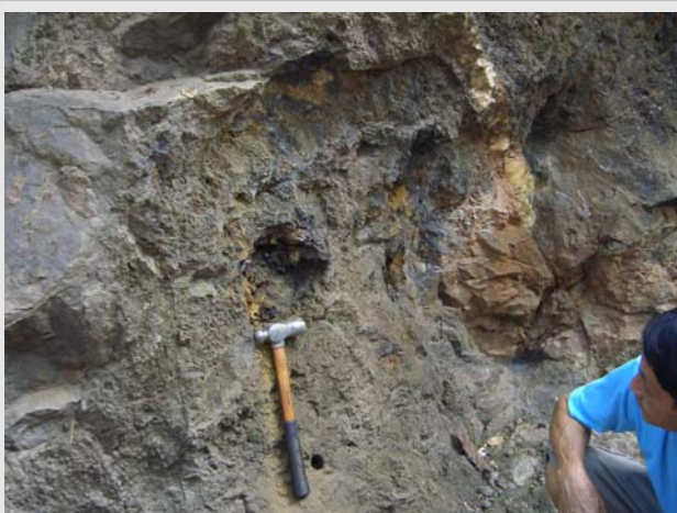
รูปที่ 6-18 สายแร่แมงกานีสตามแนวรอยเลื่อนที่ ตัดผ่านหินควอตไซต์ ทิศทาง N15W
