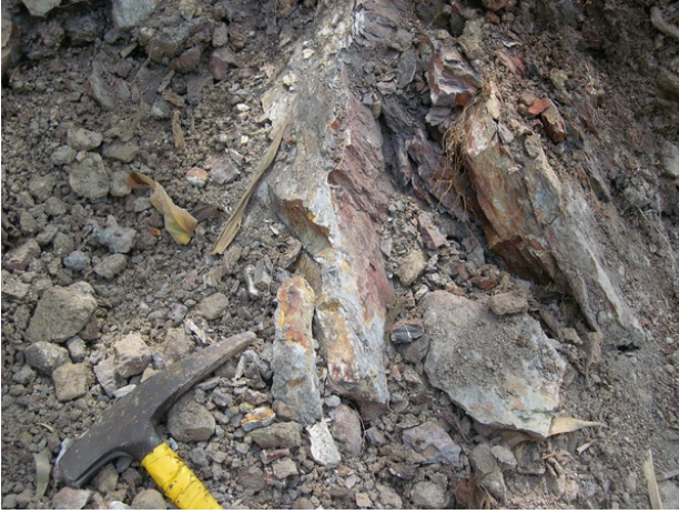
รูปที่ 3-3 ลักษณะของหิน quartzitic phyllite ที่พบ บริเวณภูผาดัก อำเภอสังขม จังหวัดหนองคาย (0198895E /2014776N, 5445 III)
