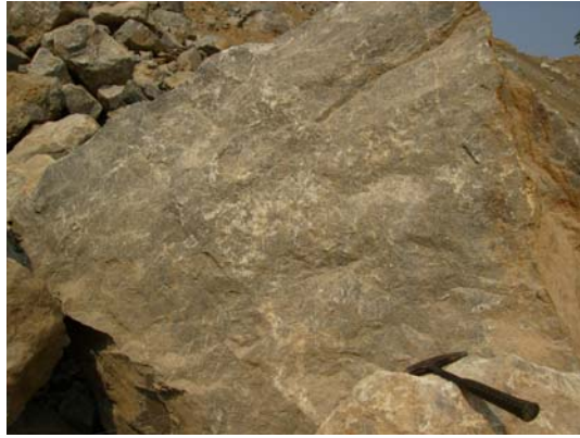
รูปที่ 6-5 ลักษณะเนื้อหินปูนเพื่ออุตสาหกรรมก่อสร้างของเหมืองหินปูนบริษัท โซคอนันต์ อุตสาหกรรมก่อสร้าง จำกัด ตำบลอุทัยสวรรค์ อำเภอนากลาง (ค่าพิกัด 194498E/1911376N)
