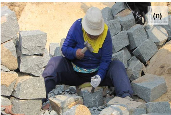
รูปที่ 6-12 แหล่งหินแกรนิตบ้านโคกเจริญ อำเภอชนแดน ซึ่งใช้การสกัดหินด้วยแรงงานคนและนำส่งเพื่อทำเป็นครกหินที่อ่างศิลา (พิกัด 703683 ตะวันออก/1789872 เหนือ, ทิศทางภาพ - ทิศเหนือ)
