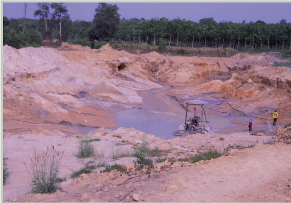
รูปที่ 6-6 การผลิตทรายบดจากตะกอนตะพักแม่น้ำจันทบุรี บริเวณท่าทรายวนิดา-สมฤกษ์
