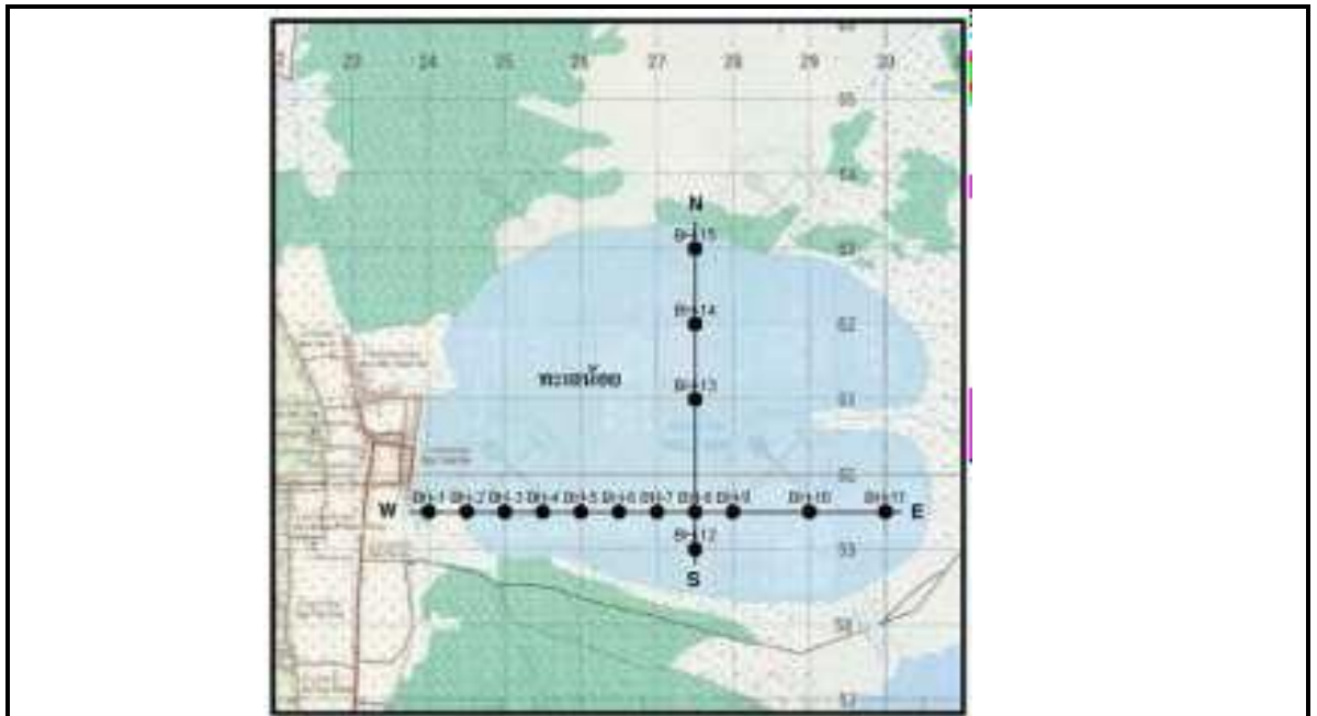
รูปที่ 3.16 แผนที่แสดงการเจาะสำรวจทะเลน้อย 15 หลุม (คัดลอกจากสุวิทย์ เสรีตระกูลและคณะ, 2549)
