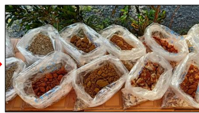
ตัวอย่างมาตากให้แห้ง แล้วชั่งน้ำหนักอีกครั้ง เพื่อนำมาหาค่าความถ่วงจำเพาะต่อไป
