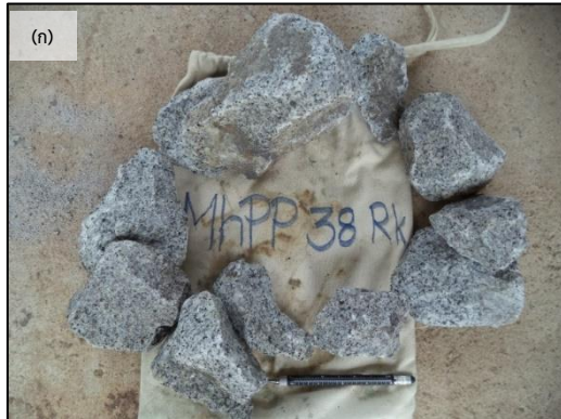
(ก) การเลือกเก็บตัวอย่างหินสด โดยกะเพาะผิวหินผุออก
