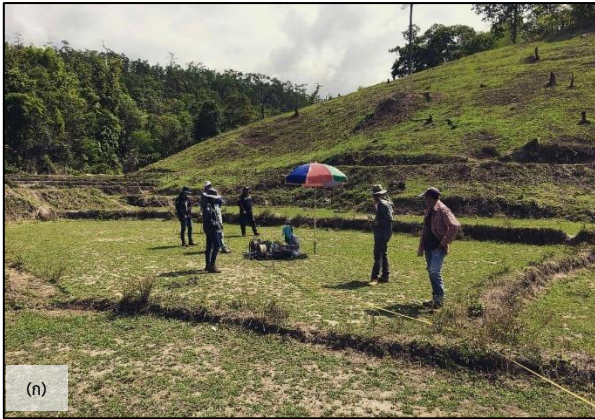
(ก) การสำรวจทางธรณีฟิสิกส์ ด้วยวิธีการวัดค่าความต้านทานไฟฟ้าแบบหยั่งลึก
