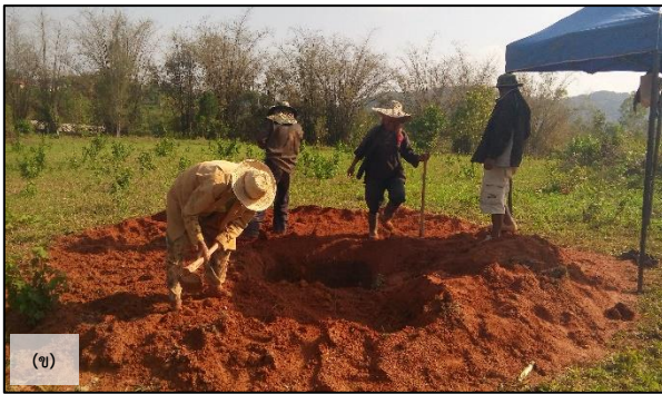
(ข) การขุดหลุมทดลองเป็นหลุมสี่เหลี่ยม ขนาด 1x1 เมตร
