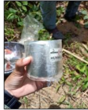
นำถุงสวมกระบอกรับตัวอย่างดิน เพื่อป้องกันไม่ให้ดินติดในเครื่องตอกเก็บตัวอย่าง
