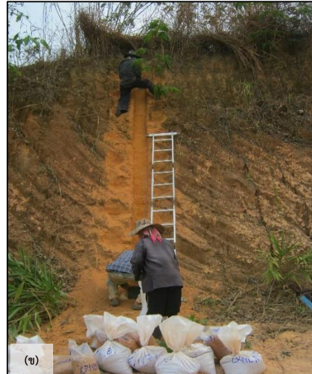
(ข) การเก็บตัวอย่างดิน โดยเก็บจากชั้นล่างสุด ขึ้นไปหาชั้นบน
