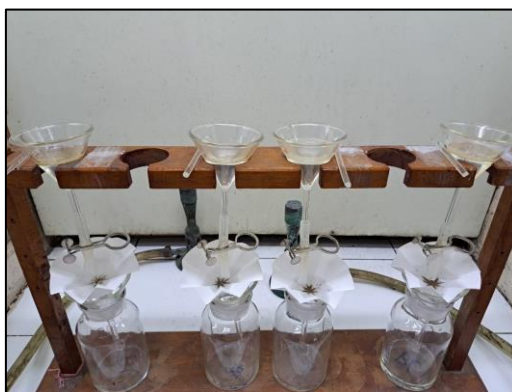
(ค) กระบวนการลอยแร่ด้วยสารโบรมอฟอร์ม (bromoform) เพื่อแยกกลุ่มชนิดแร่หนักกว่าออกจากแร่ที่เบากว่า
