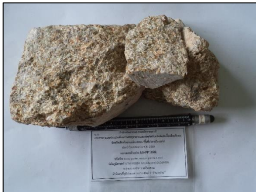
(ก) การคัดเลือกตัวอย่างหิน พร้อมทั้งแบ่งตัวอย่างหินด้วยเครื่องตัดหิน
