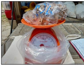
นำตัวอย่างมาชั่งทันที เพื่อดูความคลาดเคลื่อนของน้ำหนักตัวอย่าง (ถ้าตัวอย่างไหนมี Qtz/pegmatite vein/อื่นๆ ที่ทำให้น้ำหนักต่างกัน ให้ remark ด้วย)
