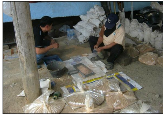
(ง) การเตรียมตัวอย่างดิน/หินผุ ใส่ถุงซิปลเพื่อเตรียมส่งวิเคราะห์เคมี และจัดเก็บเป็นตัวอย่างอ้างอิงและศึกษาต่อยอด
