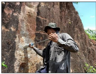
ตอกเก็บตัวอย่างในแต่ละช่วงที่เก็บตัวอย่าง ชั้นละ 2 ตัวอย่าง (ปรับเปลี่ยนได้ตามความเหมาะสม ขึ้นอยู่กับค่าน้ำหนักที่ได้ และลักษณะดินการเก็บในแต่ละจุด)
