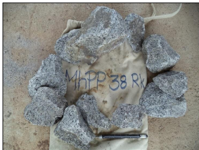
รูปที่ 5.2 การคัดเลือกตัวอย่างหินสด เพื่อเตรียมส่งวิเคราะห์เคมี ศึกษาทิวลาพรรณนา และเป็นตัวอย่างอ้างอิงและศึกษาต่อยอด
