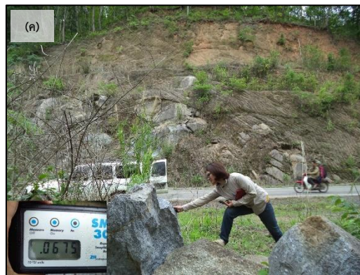
(ค) การค่าการยอมรับสภาพความเป็นแม่เหล็กของหินโผล่
