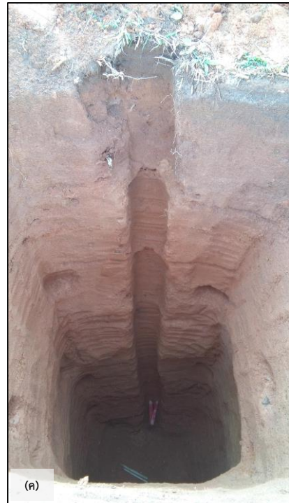
(ค) การเก็บตัวอย่างชั้นดินในหลุมทดลอง ด้วยวิธีการเจาะร่องเก็บตัวอย่างทุก 50 เซนติเมตร
