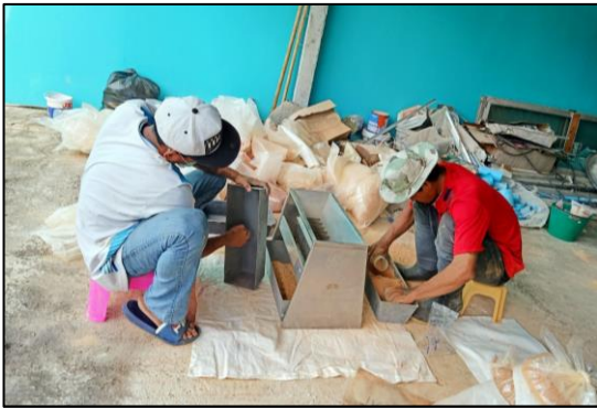
(ค) การแบ่งตัวอย่างดิน/หินผุ ด้วยเครื่องแบ่งตัวอย่างดิน (sample splitter)
