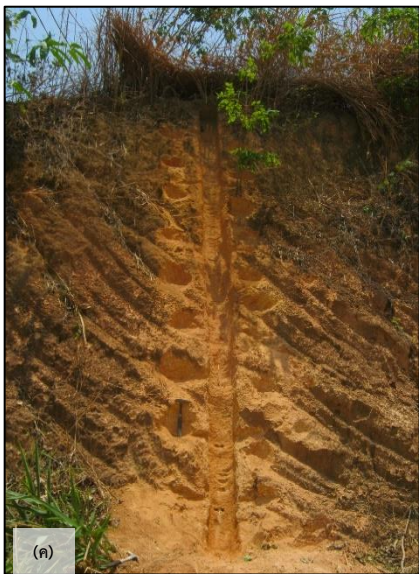
(ค) ลักษณะการเขาระ่องเก็บตัวอย่างดิน ตลอดทั้งความยาวหน้าตัดชั้นดิน
