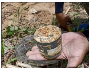
นำกระบอกรับตัวอย่างออกจากหน้าตัดดิน (ถ้าดินล้นกระบอกรับ ให้ปาดดินออก ให้ได้ปริมาณพอดีกับกระบอกรับ)
