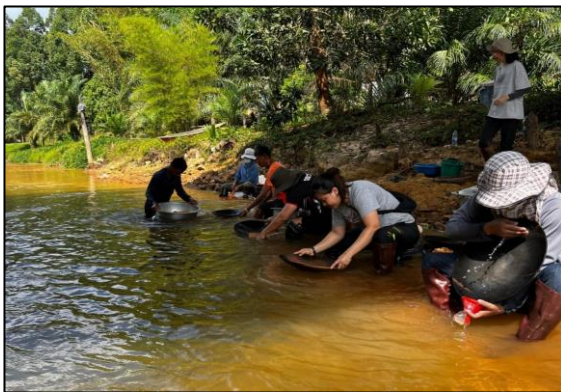
(ก) การล้างตัวอย่างดิน/หินผุ ด้วยวิธีการเลียงแร่
