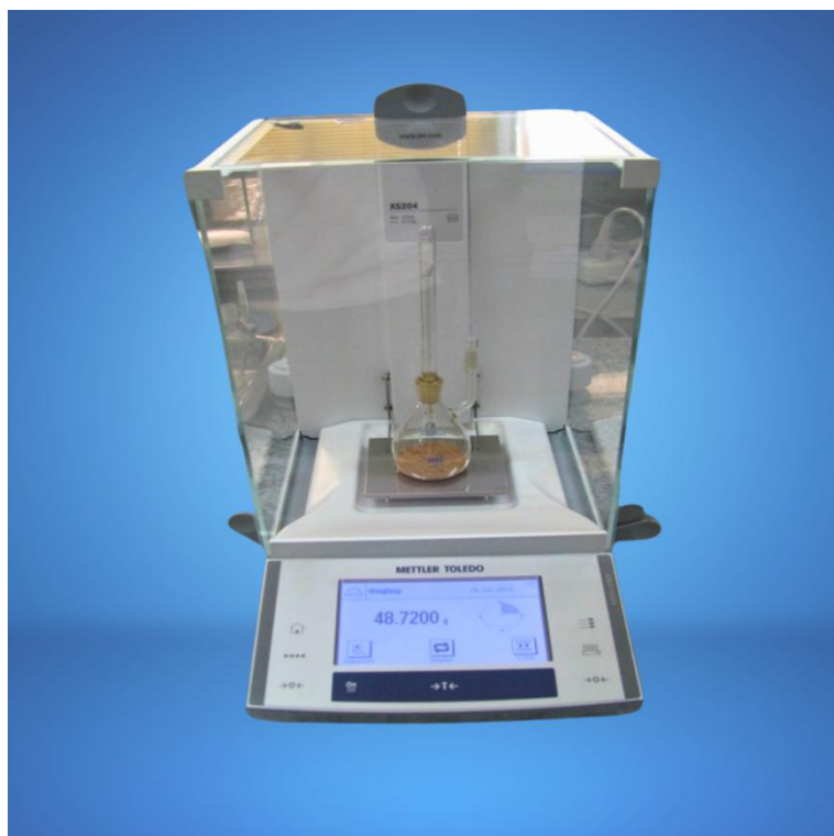
รูปที่ จ-8 เครื่องชั่งหาค่าความถ่วงจำเพาะ (Specific gravity determination balance)
