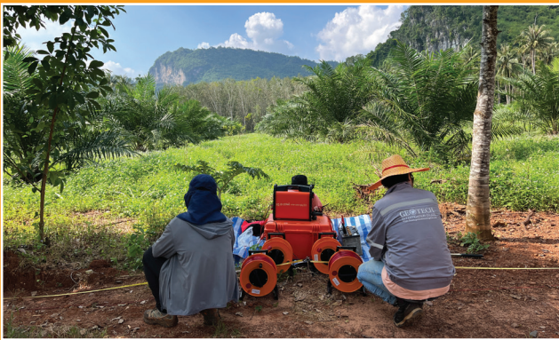
การสำรวจธรณีฟิสิกส์ด้วยวิธีวัดค่าสภาพต้านทานไฟฟ้า บริเวณพื้นที่หลุมยุบ อำเภอสวี จังหวัดชุมพร
