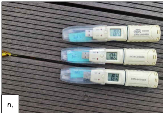
รูปที่ 3.5.3-1 เครื่องมือที่ใช้เก็บข้อมูลเพื่อติดตามสภาพอากาศในแต่ละถ้ำของระบบถ้ำผีหัวโต
