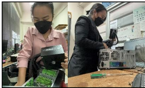
รูปที่ ๔ ภาพแสดงการซ่อมแซมอุปกรณ์ที่ชำรุดด้านฮาร์ดแวร์
