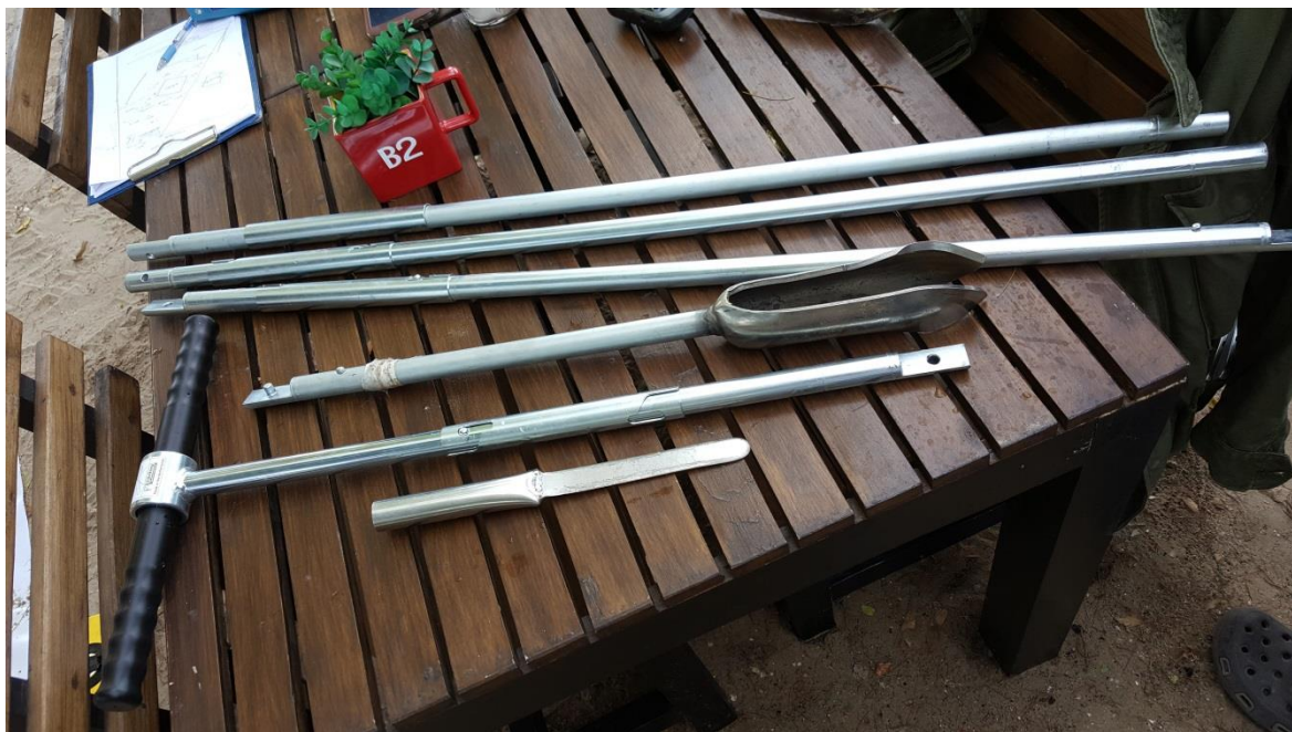
รูปที่ 5 เครื่องเจาะชนิดมือหมุน (hand auger drilling sets)
