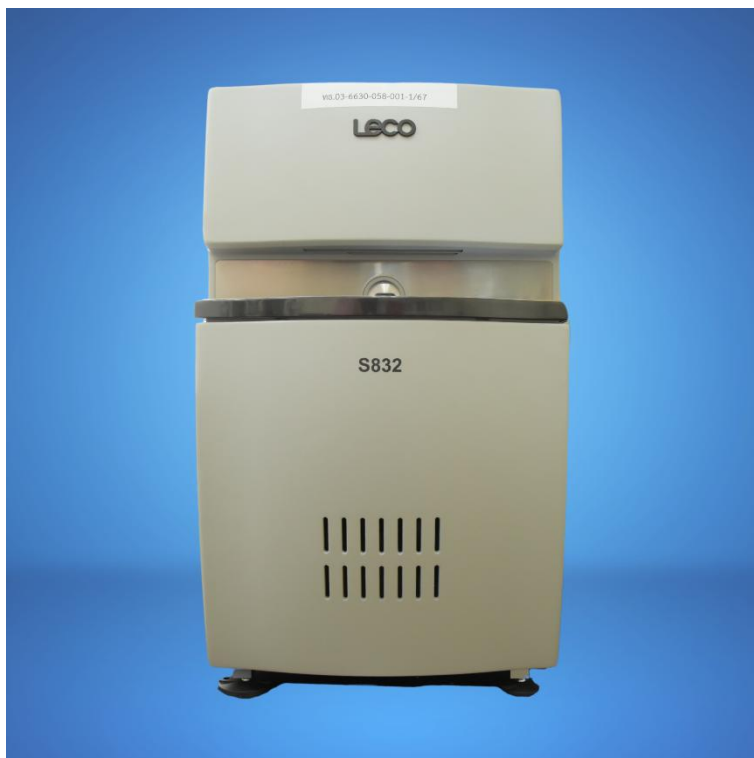
รูปที่ ง-12 เครื่อง Sulfer Determinator วิเคราะห์ปริมาณซัลเฟอร์
