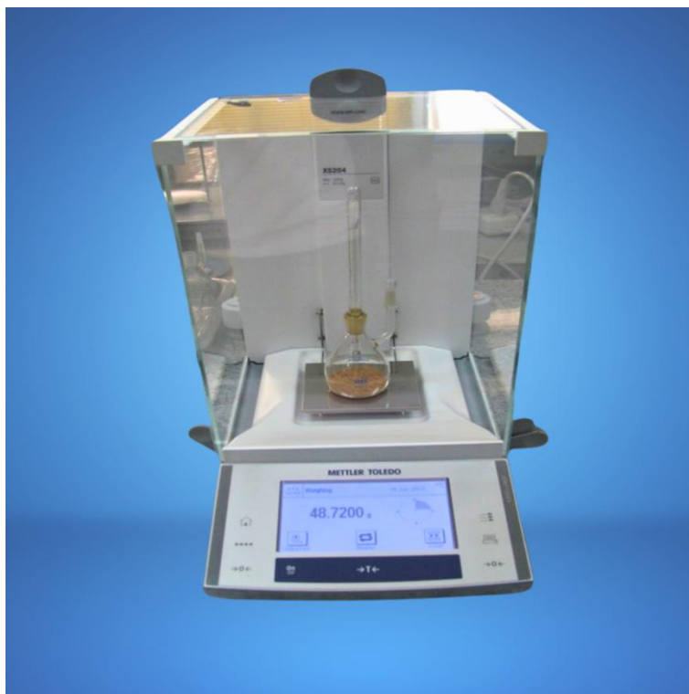
รูปที่ ง-8 เครื่องชั่งหาค่าความถ่วงจำเพาะ (Specific gravity determination balance)
