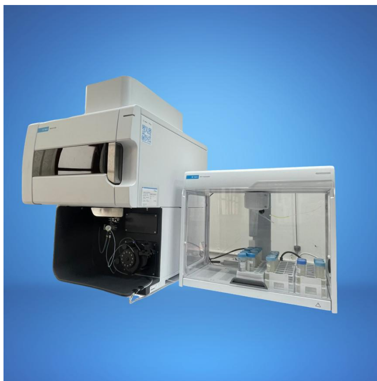
รูปที่ ง-14 เครื่อง Inductively Coupled Plasma Optical Emission Spectrometer ; ICP-OES
