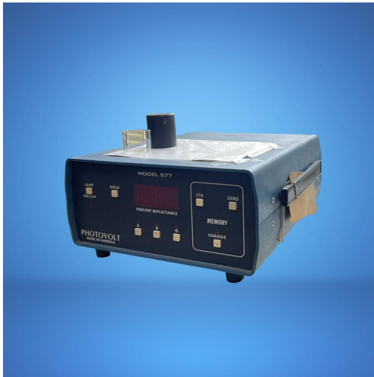
รูปที่ ง-7 เครื่องตรวจความขาวสว่าง (Brightness)
