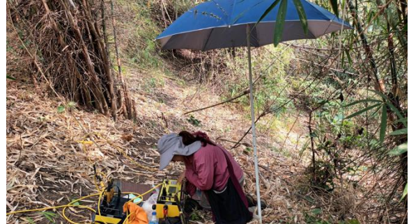
การสำรวจวัดค่าสภาพต้านทานไฟฟ้า พื้นที่สำรวจ อำเภอแม่เมาะ จังหวัดเชียงใหม่
