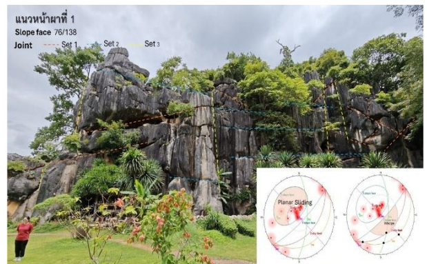
ลักษณะแนวหน้าผาเส้นทางท่องเที่ยว แหล่งมรดกธรณีสวนหินผางามที่มีโอกาสเกิดการเคลื่อนตัวของมวลหินแบบลิ้ม และแบบระนาบ
